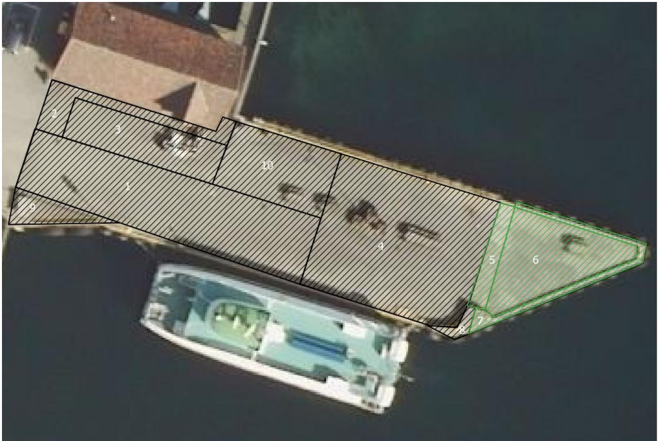
Figur 2: Oversikt over kartlagte betongelementer. Elementer markert med svart overskrider grenseverdier for gjenbruk og må behandles som avfall. Elementer markert i grønt overskrider ingen grenseverdier og kan gjenbrukes som fyllmasser uten særskilt tillatelse.
